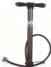
Bombas manuales de alta presión y gran caudal. Con diseño muy robusto, de dos cuerpos independientes sobre la base de aleación de zinc. Presión máxima de servicio: 12 bar. De 400 cc. Grande. Tractor y camión.
