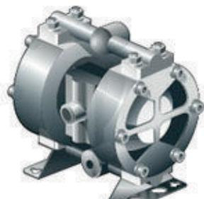
BOMBA NEUMATICA DIAFRAGMA DE POLIPROPILENO 20L./Min. Medio caudal 175L/min. Salida 3/8 de diametro. Presion max. Salida 100Lbs..
